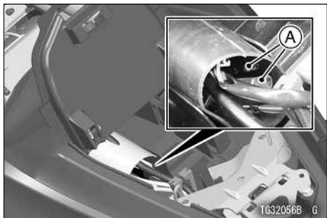
A. Szivargyújtó csatlakozók (a burkolat alatt)
