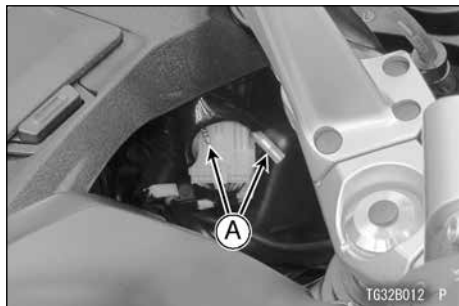
A. Szivargyújtó csatlakozó (a bal belső burkolat mögött)
